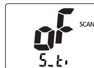
Suchlaufwiederaufnahme-Timer AUS (voreingestellt)
